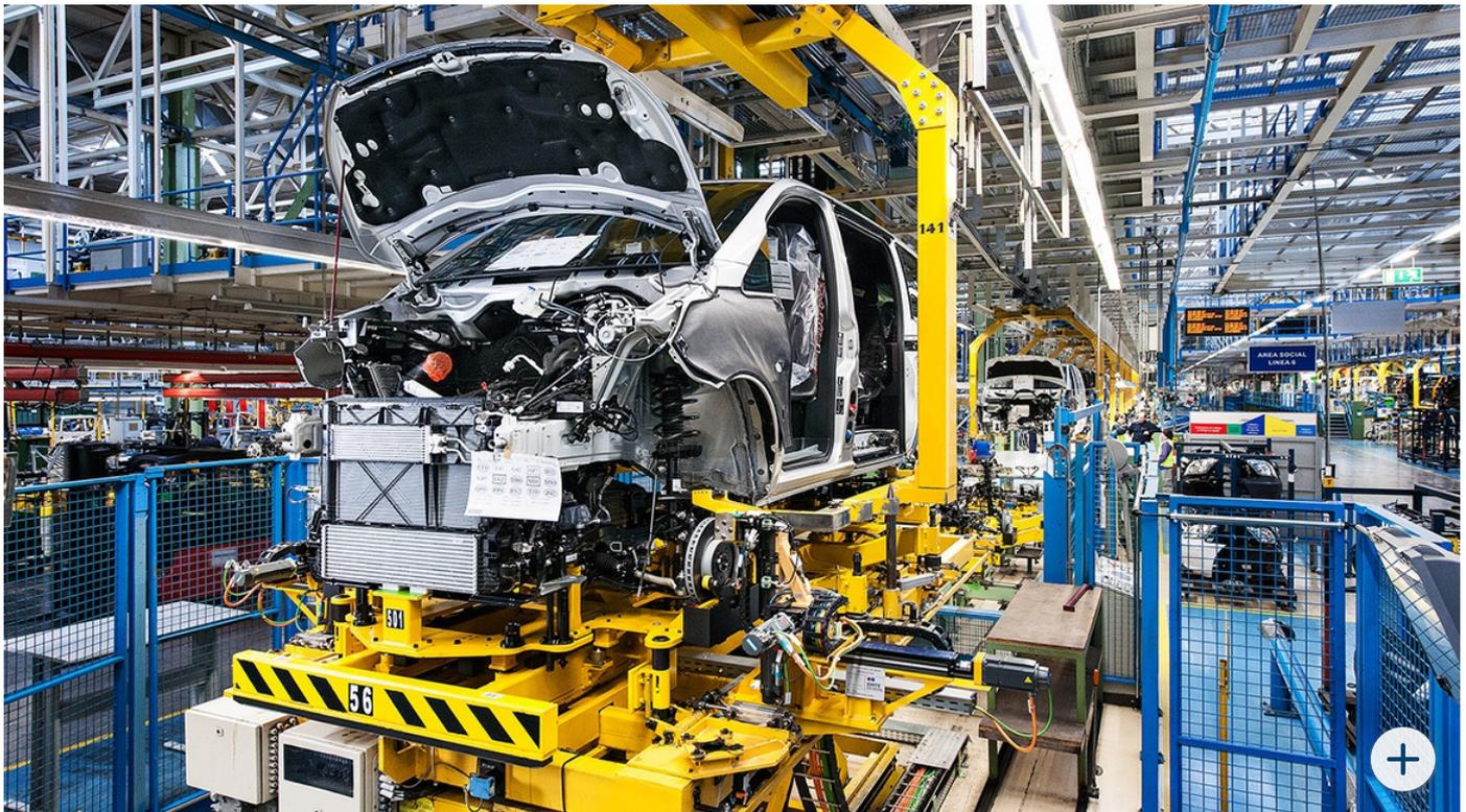
Karosserie und Getriebe eines Autos werden zusammengeführt. "Hochzeitsstation" in einem Werk der Daimler AG. © Daimler AG
